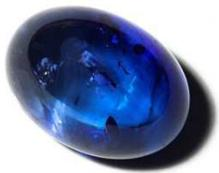
Wegen seiner im Vergleich zu anderen isolierenden Materialien hohen [Wärmeleitfähigkeit](#) von 40 W/(m • K) bei einer Temperatur von 25 °C greift man in wissenschaftlichen Experimenten zu Scheiben aus diesem Material, wenn etwa eine **effektive Kühlung oder eine genaue Temperaturregelung** durch ein zum Zwecke der Beobachtung durchsichtiges Medium hindurch erfolgen muss.
