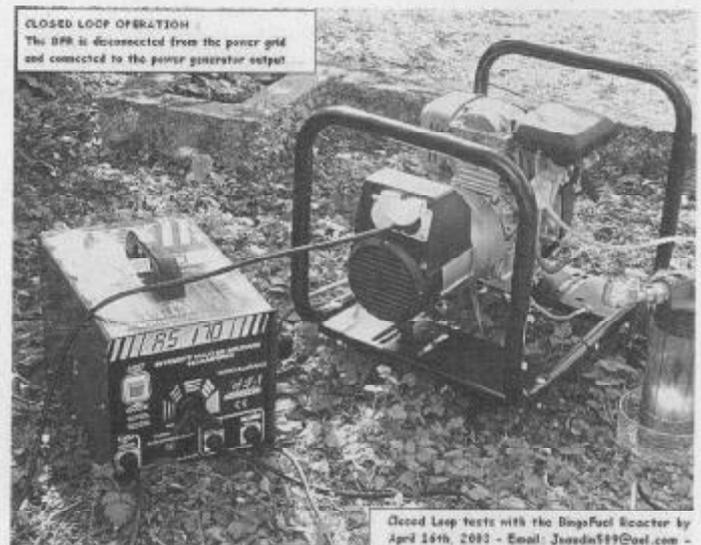
Der Bingo-Fuel-Reaktor (rechts) erzeugt Brenngas für eine Notstrombaugruppe, die den Transformator speist, der den erforderlichen Strom zum Betrieb des Bingo-Fuel-Reaktors liefert („Close-Loop“-Betrieb).
