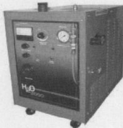
Kommerzieller Klein-Gasgenerator mit 5 kW Leistungsaufnahme mit Langzeitstabilität.
