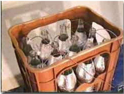
Bei dem Flaschenkondensator ist außen Alufolie und innen entweder auch Alufolie oder Salzwasser. Das Glas ist das Dielektrikum. Zwischen der Alufolie außen und dem Salzwasser innen, kann sich ein elektrisches Feld aufbauen. Die Spannungsfestigkeit ist bei 3mm Glasstärke ca. 10000V. Die Kapazität ist für eine 0,7l -Wasserflasche bei 0,5 bis 1nF an zu setzen.
